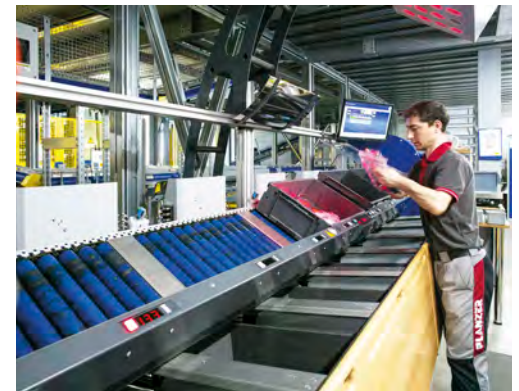
Mit dem vollautomatischen Kleinteillager (AKL) kommissionieren wir beispielsweise Produktionsteile für Kaffeemaschinen.
